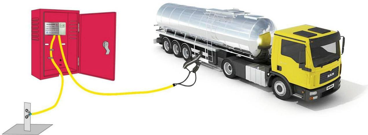
固定式静电接地报警器使用示意图
